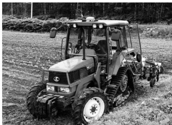
▲GPS搭載トラクター（屋根の円盤が特徴）
